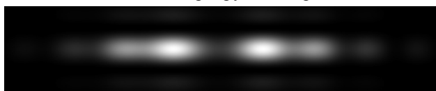
Рис. 8. Распределение интенсивности в фокальной плоскости для линз с диаметром D=40 мкм из табл. 1.
